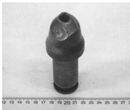
Рис. 4.5. Износ резца РШ32-70/16SK: оторван керн и изношена головка резца
