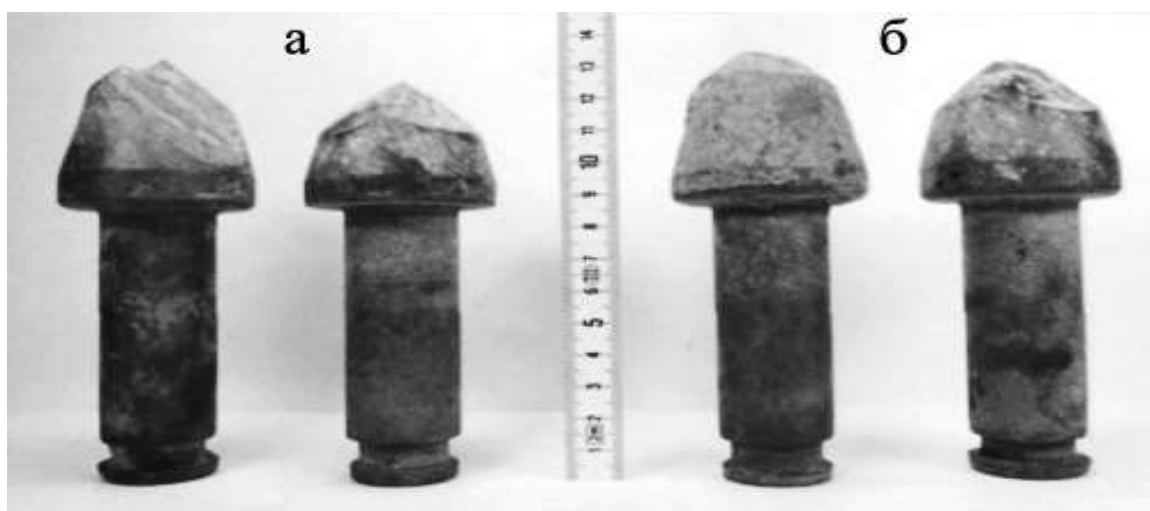
Рис. 4.3. Характер износа резцов РШ33-85/17,5
