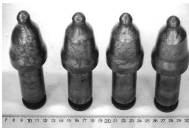
Рис. 4.6. Характерная сеть мелких трещин в армировке резца РШ32-70/16SK
